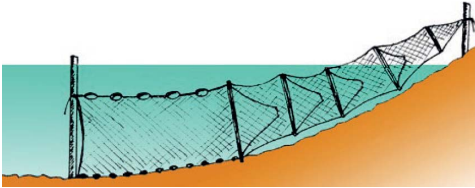
Schema di bertovello a inganno singolo (Sancho Alcayde et al., 2015)
