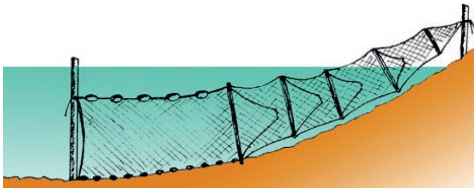
Schema di bertovello a inganno singolo (Sancho Alcayde et al., 2015)
